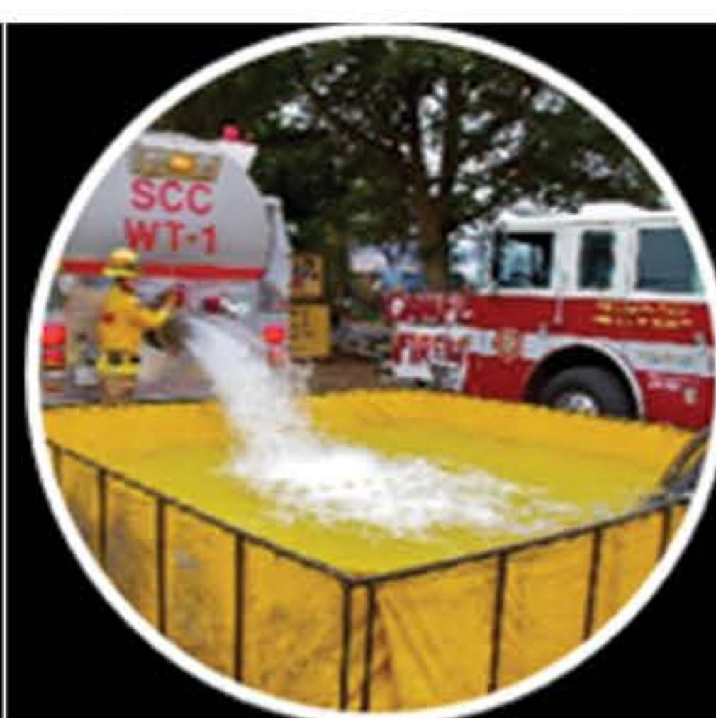
Lucha contra incendios -Llenado del tanque de agua
